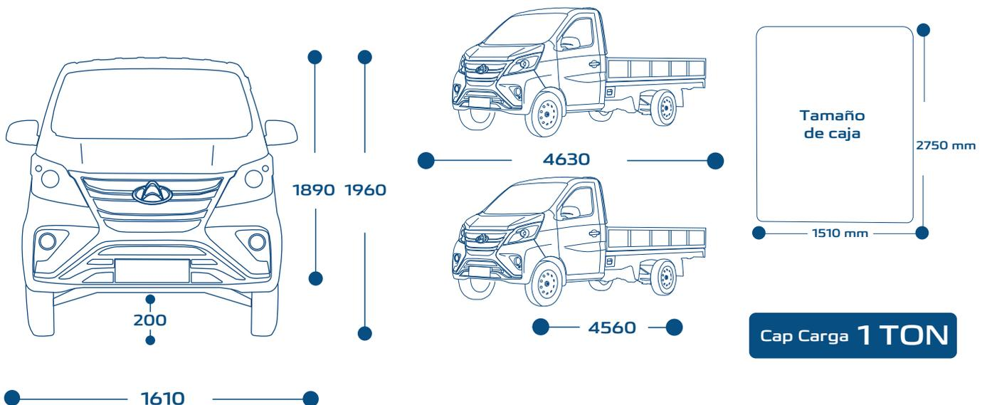
Peso 1099 kg | Largo 4630 mm | Ancho 1610 mm | Alto total 1960 mm | Altura libre al piso 200 mm
